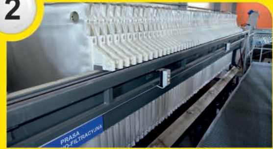
2 Wyciskanie hydrauliczne osadów w prasie komorowej
